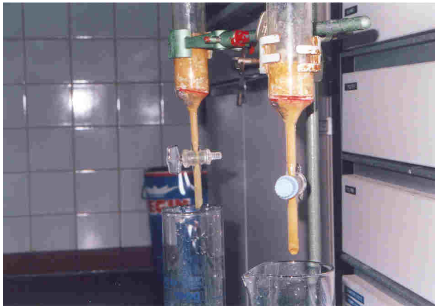
Abb. 25: Auftretende, zeitweilige Verstopfungen im Bereich des Kükens
