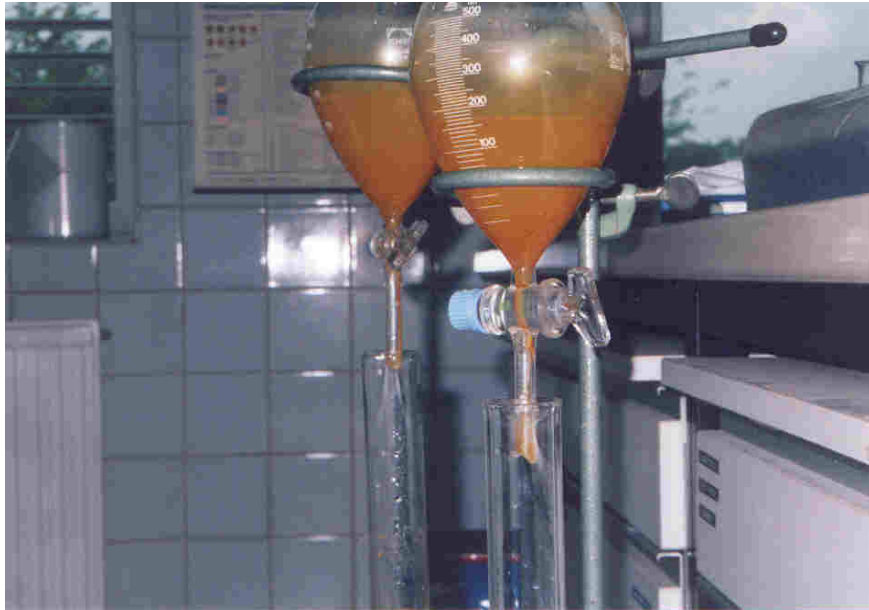
Abb. 24: Fe- Ausfällung im Scheidetrichter
