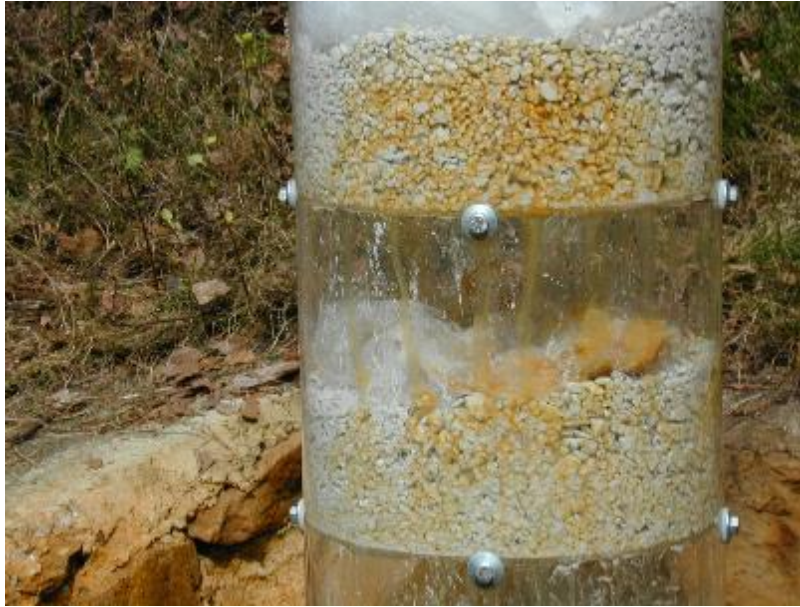
Abb. 20: Orangefärbung von Kreidekalkkörnern und des Adsorbens durch u.a. Fe-Hydroxidfällung
