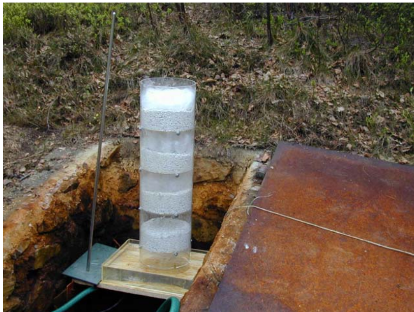
Abb. 2: Plexiglasturm mit 4 Siebböden, Versuchstechnik vor Ort in Bodenmais
