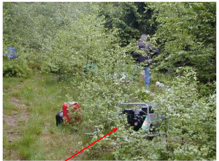
Abb. 18: Stromaggregat, das die Tauchpumpe betreibt
