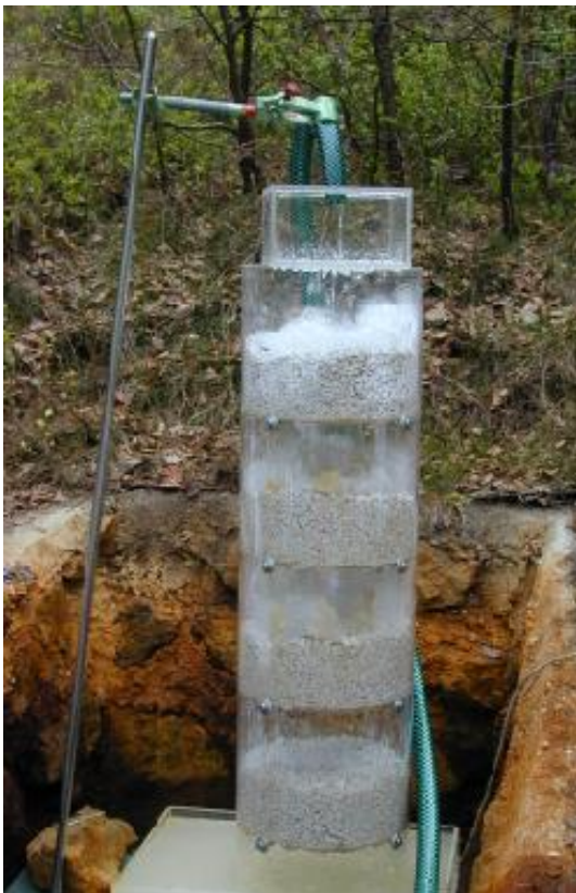
Abb. 17: Plexiglasturm gefüllt mit Kreidekalk und Quarzwolle als Adsorbens, Versuchstechnik vor Ort
